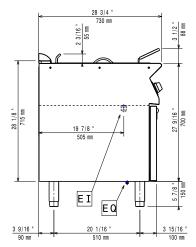
Electrical inlet (power) Equipotential screw
